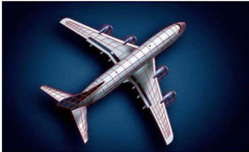
图 1-14 飞机材料中植入光纤进行全分布式监测的示意图
