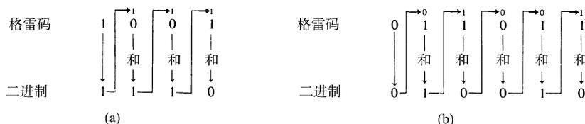
图 2-10 格雷码-二进制转换
