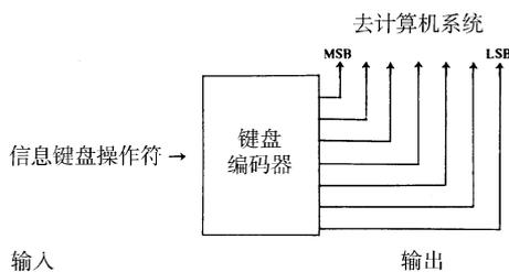
图 2-12 ASCII 键盘—编码系统
