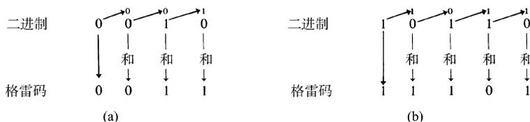
图 2-9 二进制数到格雷码的转换
