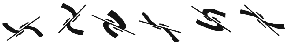
图 2.6 断层带中的牵引褶皱
